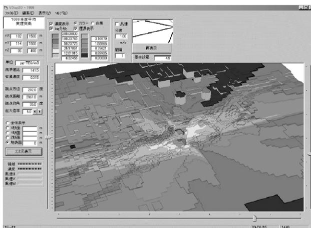
図5 神奈川県厚木米軍基地隣接産業廃棄物焼却炉からのダイオキシン類排ガスの拡散シミュレーション（3次元流体モデル：年平均濃度予測結果の例）
